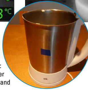
Bild 25: Auf Isolierband – annähernd genaue Temperatur
