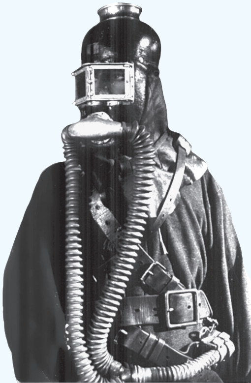
Schlauchatmer mit handbetriebenem Blasebalg Baujahr 1878
