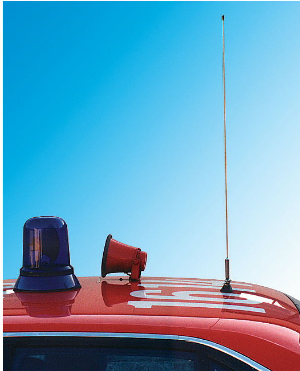
\lambda/4 - Strahler z. B. für Fahrzeug- Funkanlagen
