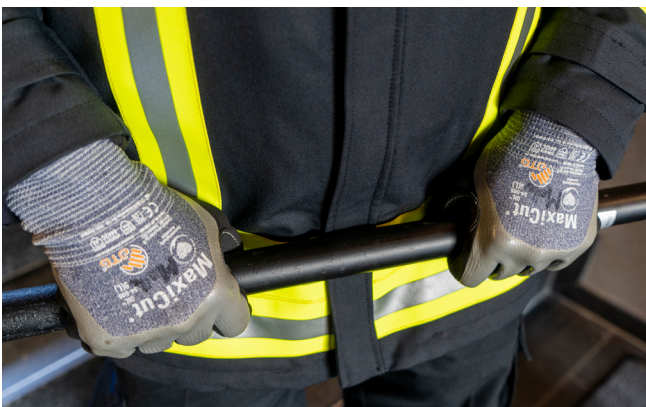
Brechstange oder Unterflurhydrantenschlüssel fassen, beide Hände vor den Körper
