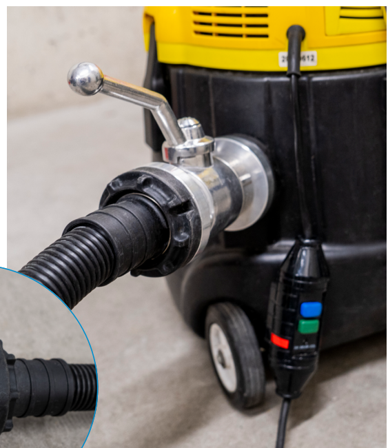
Wasserauger mit Absperrorgan und formfestem Schlauch
