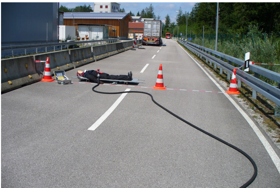
Abbildung 13: Variante mit S-Schlauch. Durchflussmenge am Rohr so gering wie möglich, aber so viel wie nötig
