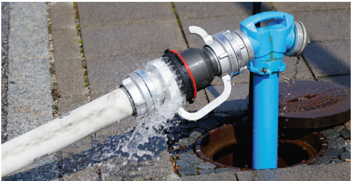
Abb. 18 Systemtrenner (Funktion bei Druckschlag) (Quelle: SFSG)
