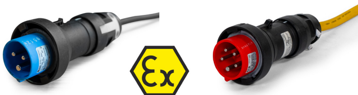
Abb. 33: Stecker bzw. Steckdose - 230 V; explosionsgeschützt (II 2G, Ex de, IIC, T6), 16 A, 3P (1P+N+PE) nach DIN
