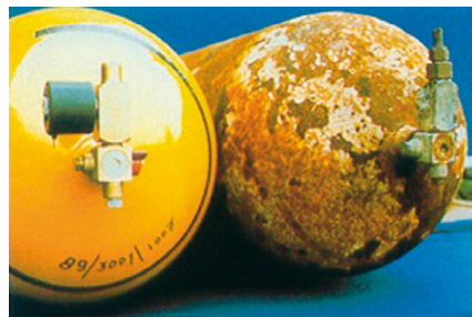
Bild 16: Flaschen(ventile) vor und nach der Flammeneinwirkung
