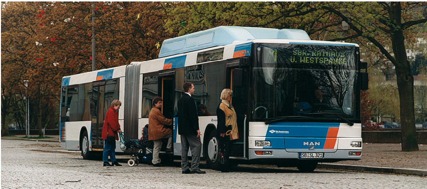
Bild 14: Erdgasbehälter auf dem Fahrzeugdach eines Omnibusses
