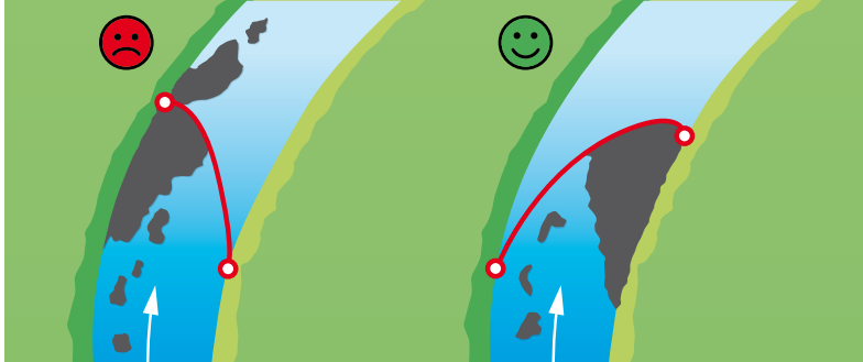
Abb. 12 Einbringen in Flusskrümmungen
