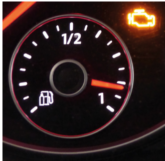
Abb. 11 und Abb. 12 Erdgasfüllstand- anzeige und Tankstutzen eines Erdgasfahrzeuges
