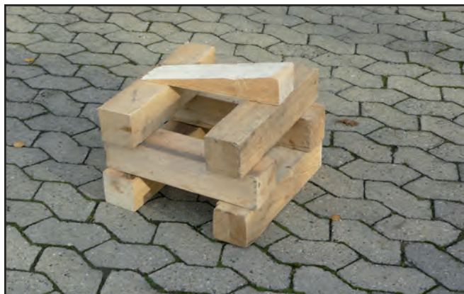
Stabiler Unterbau durch Kreuzverband von Kanthölzern
