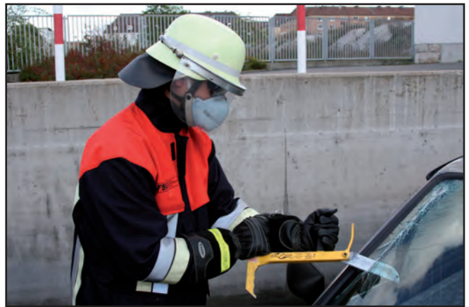
Beim Sägen von Glasscheiben auf Schutz vor Glasstaub achten
