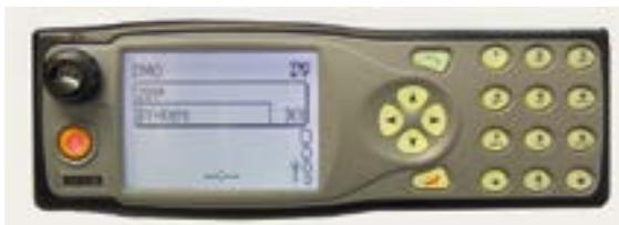
In der Regel verfügen Digitalfunkgeräte über einen GPS-Empfänger, wie man es auch von Navigationsgeräten kennt.
