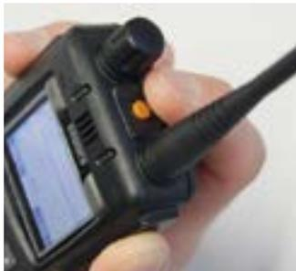
Alle Geräte im BOS-Digitalfunk, sowohl Handfunkgeräte als auch Fahrzeugfunkgeräte, verfügen über einen roten Notrufknopf. Auch am abgesetzten Bedienteil eines Handfunkgeräts ist ein Notrufknopf vorhanden.
