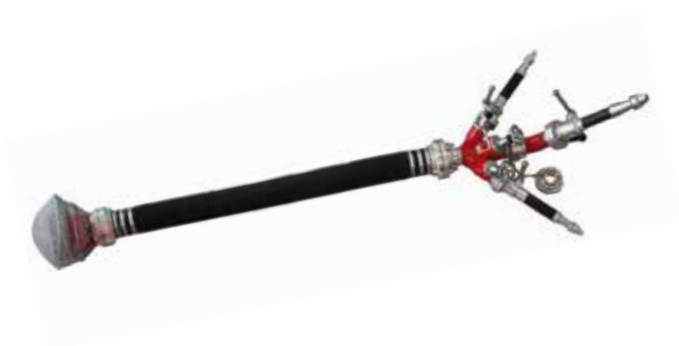
„Armaturengebilde“ aus Armaturen bei Wasserentnahme aus offenem Gewässer
